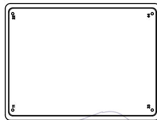
No. 2 盖上盒盖并在四周订上订书钉 真空盒盖规格: SB-24B0 (369*280*18mm)
